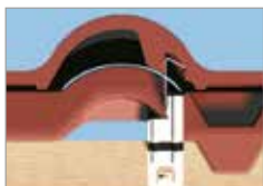
Achter in de pan is een uitsparing gemaakt, waarin de kop van de Multi klikhaak met z'n veerspanning vastklemt.
